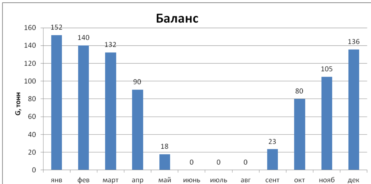
Рисунок 6.1.1. Расход газа котельной МУП "РКС"
