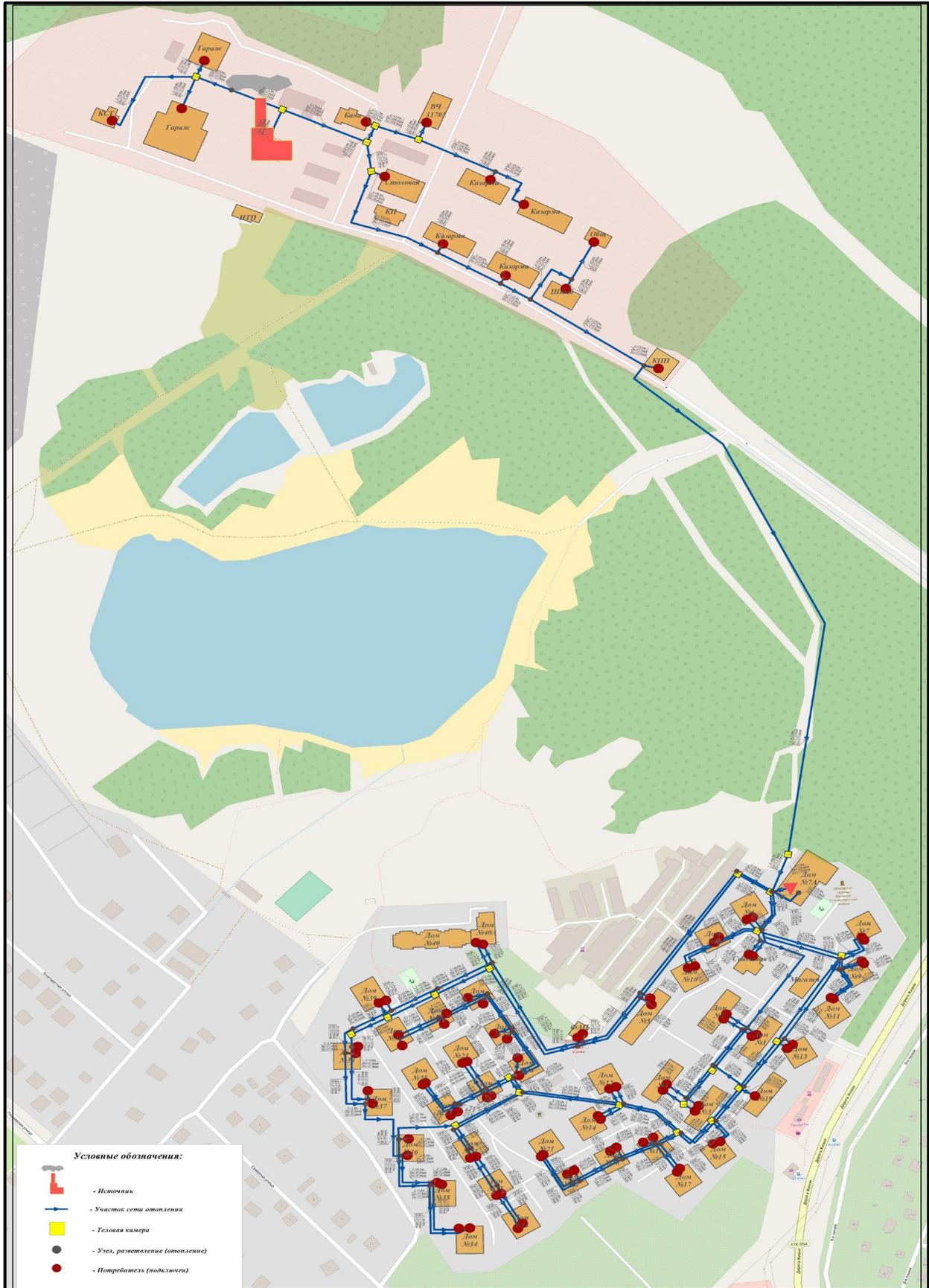
**Рисунок 3.1.2 – Графическое представление объектов системы теплоснабжения Котельной №8/30 пос. Углого**
